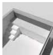
Versteifte Sitzbank mit Treppe für Rollo Einbau STR2
